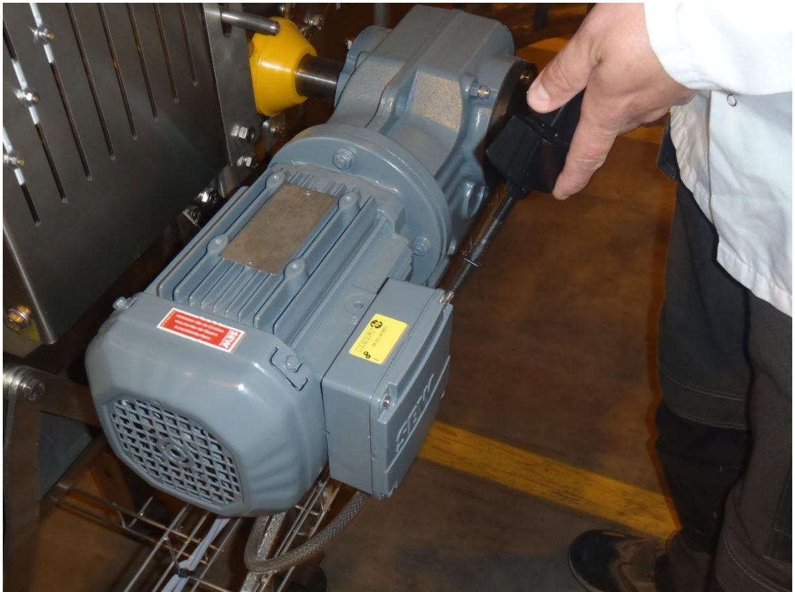
Kuva 4. Suojajohtimen jatkuvuusmittaus moottorin kotelosta.
