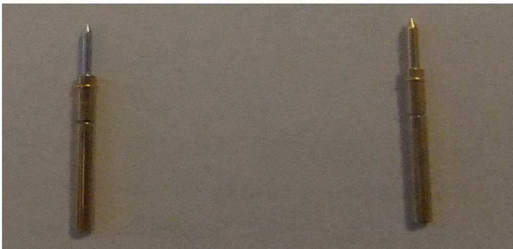
Kuva 19. CAL4-määrityslaitteessa käytettävät vaihdettavat kontaktipiikit
