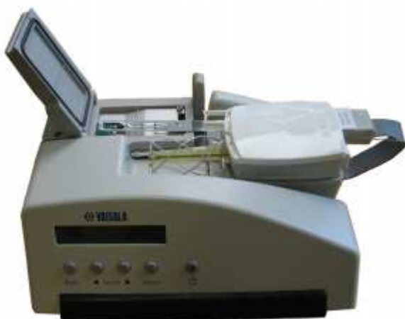
Kuva 2. GC25-maa-asema, johon on kiinnitetty Vaisalan RS92-SGP-radiosondi. [3]
