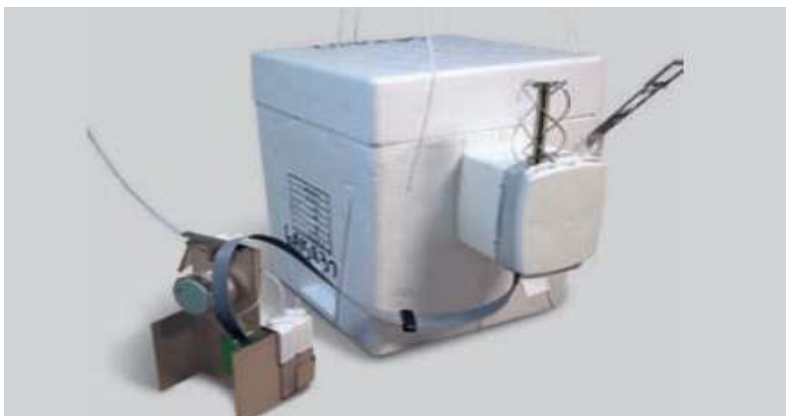
Kuva 3. Ilmakehän otsonipitoisuuden mittaukseen tarkoitettu RS92-radiosondi [4]
