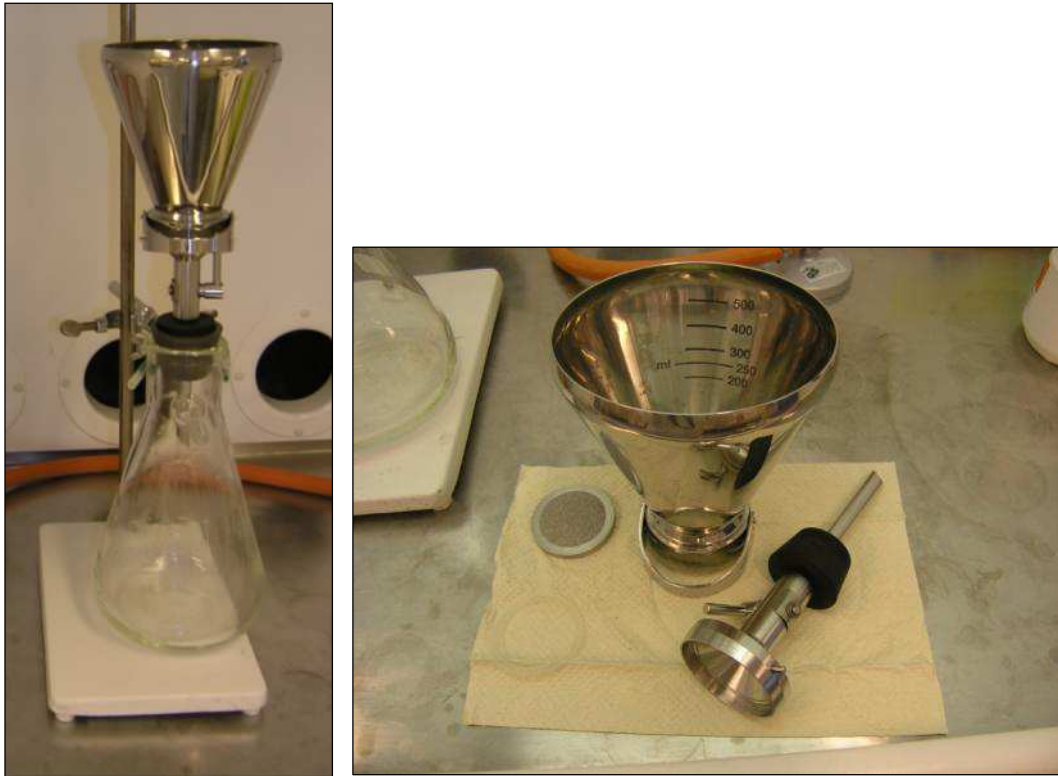
KUVA 10 ja 11. Kuvissa on nähtävissä työssä käytetty suodatuslaitteisto.
