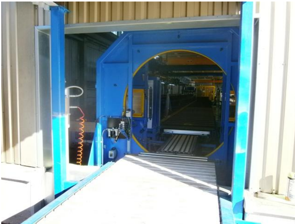
3. Valmiin seinälevyn kuljetin lastauslaiturille
