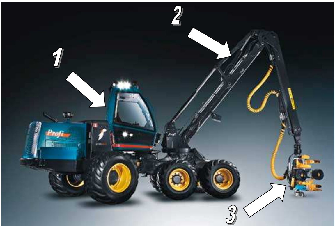
Kuva 1. Hakkuukoneen eri osat. Kuvan numerot: 1: Peruskone 2: Nosturi 3: Hakkuulaite
