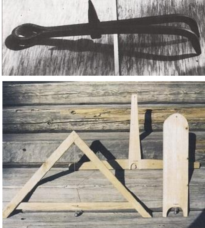
Kuva 9. Varauksessa käytettyjä työvälineitä. Ylhäällä varo ja alhaalla vatupasseja. (Vuolle-Apiala 1996: 33)
