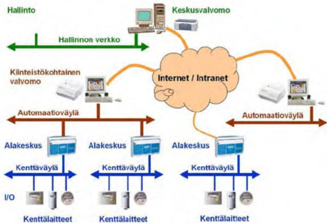
Kuvio 1. Rakennusautomaatiojärjestelmän rakenne [6]
