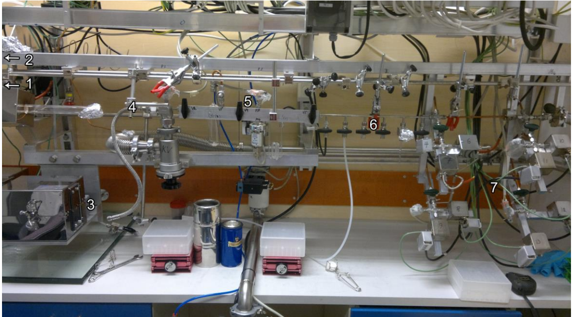
Kuva 5. HASE-linja. 1. ja 2. kuvan ulkopuolella olevat polttomoduli ja O_2 -virtaus- ja puhdistusmoduuli, 3. molekyyliseulan regenerointi- ja näytteen irrotusmoduuli, 4. liitos EA:lle, 5. CO_2 -puhdistusmoduuli, 6. varastointimoduuli ja 7. grafitointimoduuli.
