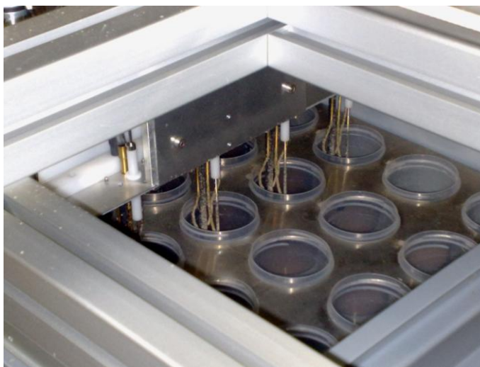
Kuva 8. Johtokykyelektrodit mittaamassa näytteitä.
