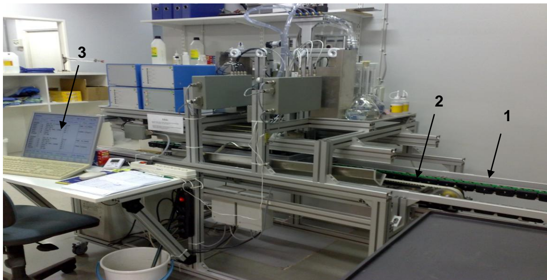
Kuva 4. Näytelaatikat asetetaan koneeseen oikealta vihreiden rullien (1) päälle. Valkoinen työntöhihna (2) työntää näytelaatikkaa eteenpäin. Koko järjestelmää käytetään tietokoneella (3).
