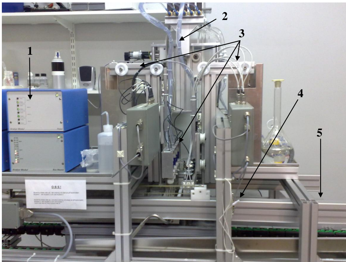
Kuva 1. pH-laitteiston osat. 1. Moduilit (4 kappaletta) 2. Vesiletkut 3. pH- ja johtokykyelektrodien hissit 4. Lämpötilan mittaus 5. Näytelaatikoiden syöttö.
