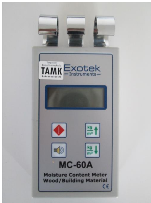
KUVA 4: Kosteusmittauksissa käytetty pintakosteuden osoitin Exotec MC-60A
