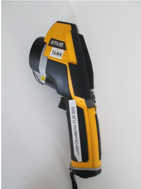
KUVA 3: Lämpökuvauksessa käytetty kamera Flir B50
