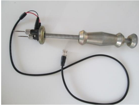
KUVA 6: Kosteusmittauksessa käytetty junta-anturi Gann M 18 johtoineen
