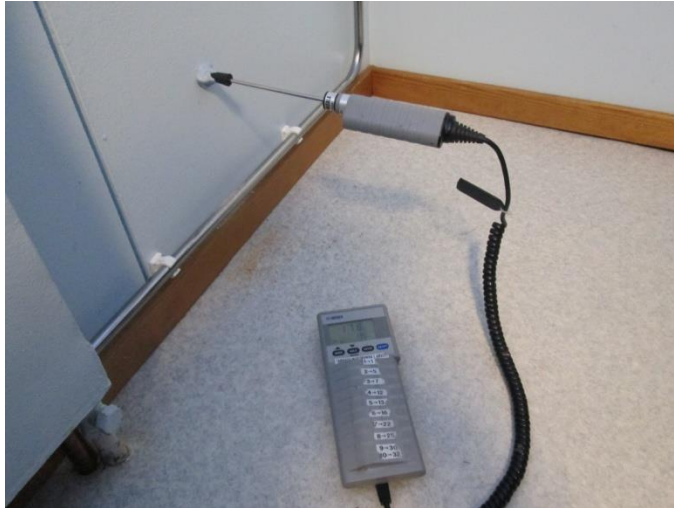
KUVA 17: Kosteusmittari poratussa reiässä sinitarralla tiivistettynä
