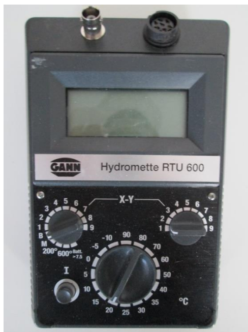
KUVA 5: Kosteusmittauksessa käytetty näyttölaite Gann Hydromette RTU 600
