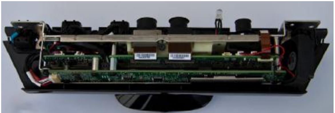
KUVIO 6. Kinectin piirilevyt (Miles 2012, 5).
