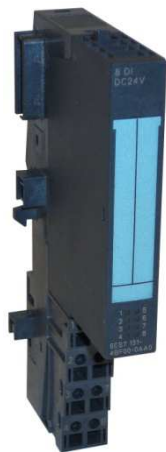
Kuvio 17. Digitaalinen sisääntulokortti ja sen piirrosmerkki
