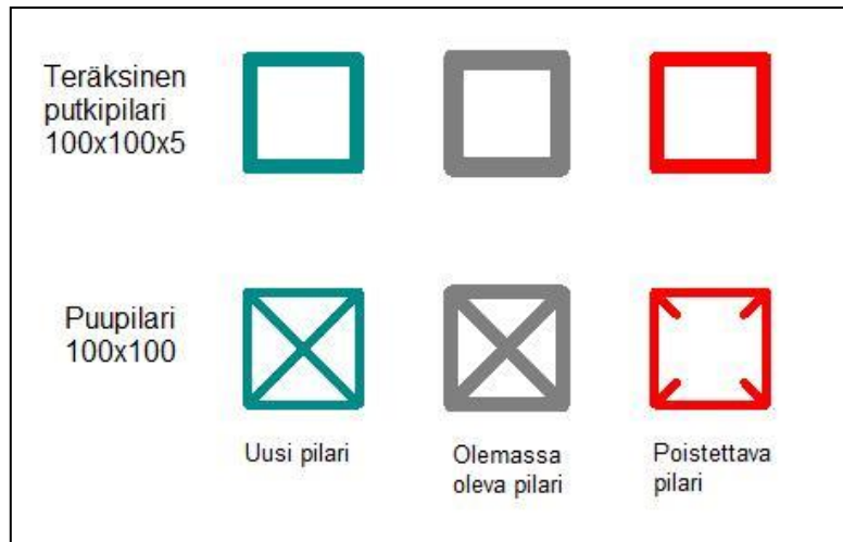
KUVA 23 Ylärivillä teräspilari ja alarivillä puupilari eri vaiheissa
