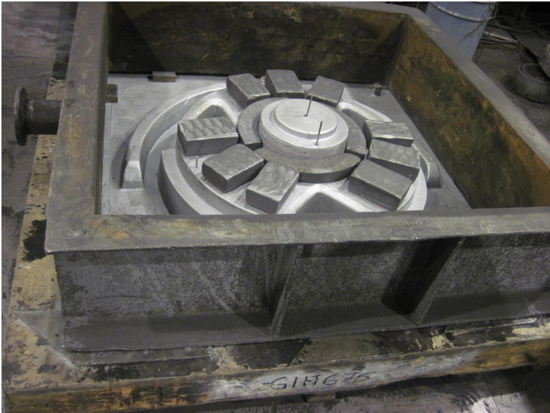
KUVA 5. Hiekkamuotin valmistus valumallin avulla kaavauskehään käsinkaavauksessa
