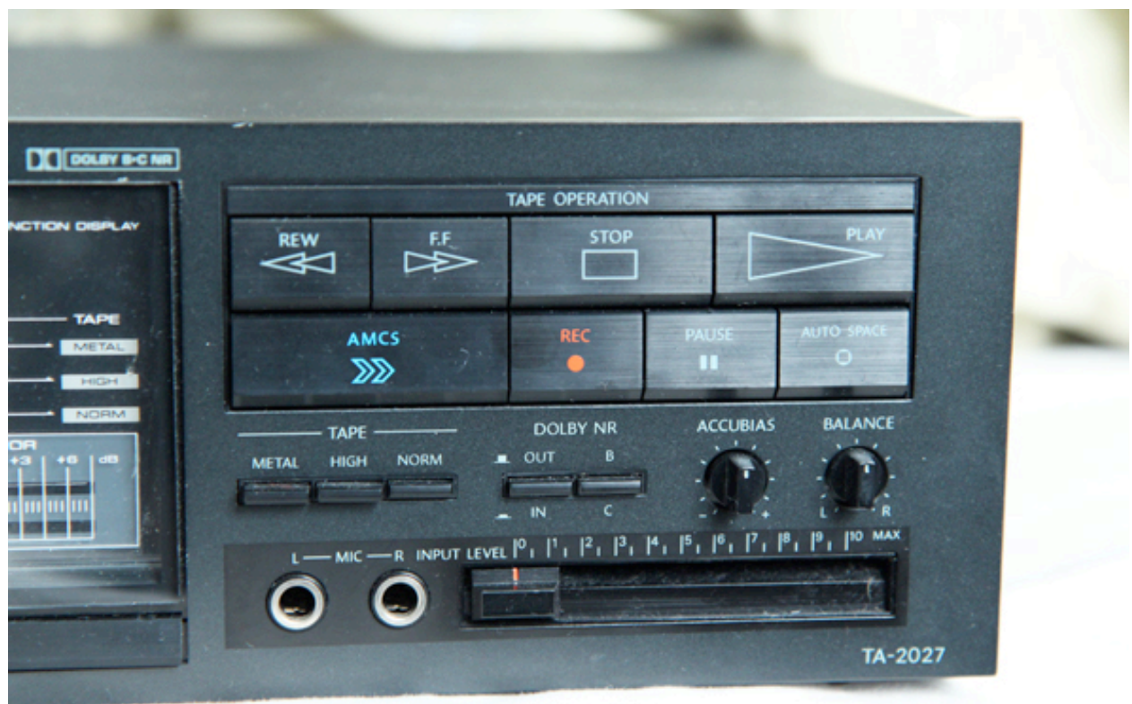
KUVA 5: Onkyo TA-2027 c-kasettinauhurin painikkeet. Kytkimet sijaitsevat mikrofoniiliitäntöjen päällä, vasemmalta oikealle: nauhatyyppinvalinta, kohinanvaimennusprofiili, bias-virran hienosäätö sekä kanavatasapainonsäätö (Kuva: Lauri Kuivanen 2013)
