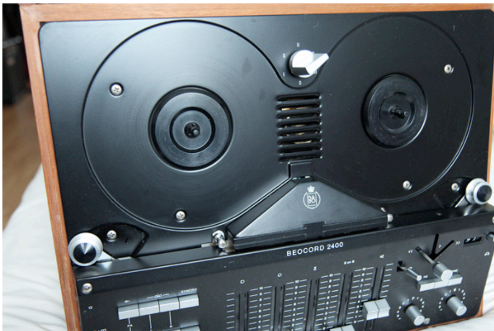
KUVA 4: Nauhanopeutta voi säädellä kuvassa keskellä olevalla kolmiasentoisella kytkimellä. Kuvassa Beocord 2400 kelanauhuri. (Kuva: Lauri Kuivanen 2013)
