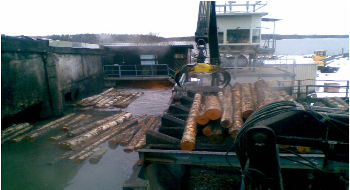
Kuva 14. Vaneritehtaan hautomon Loglift tukkinostin ja tukkien annostelu-pöytä.
