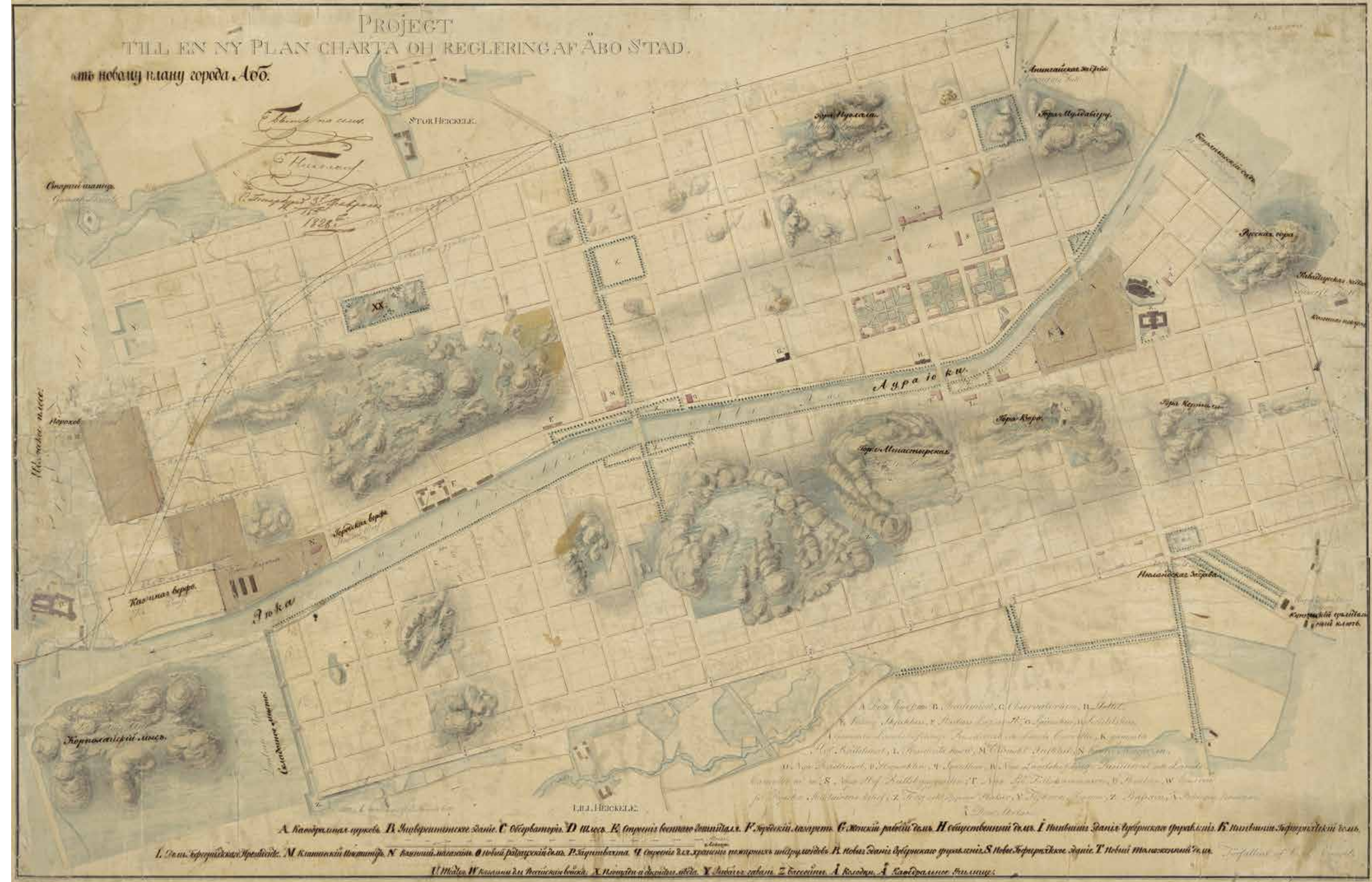
Kuva 2. Turun uusi ruutuasemakaava vuodelta 1828. Turku oli tuhoutunut pahoin tulipalossa syksyllä 1827. Arkkitehti C. L. Engel laati kaupungille uuden asemakaavan hyvin nopeassa aikataulussa. Suunnitelman tärkein tavoite oli paloturvallisuuden parantaminen. Karttaan on piirretty muutama mallikortteli, joissa on esitetty palokujanteiden järjestelyperiaatteita.
