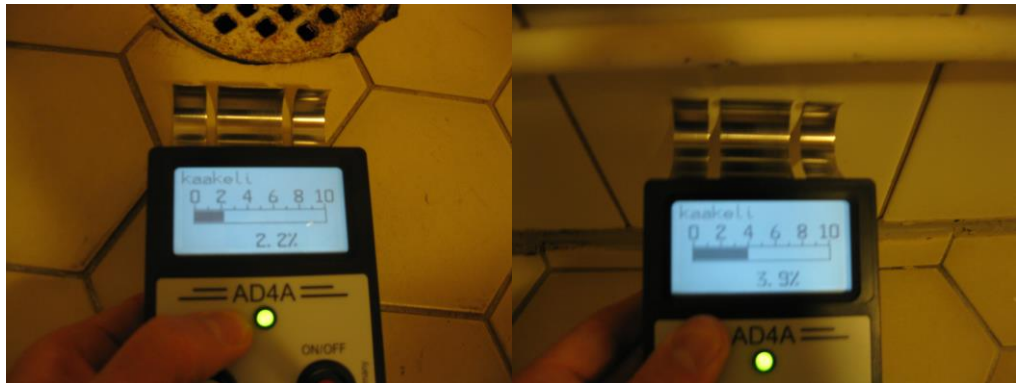
Kuvio 8. Kosteuden mittaaminen lattiakaivon sekä seinän alaosasta
