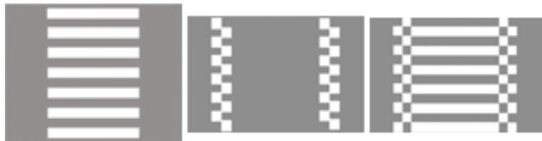
Kuva 2. Suojatien, töyssyn ja korotetun suojatien tiemerkinnot. [4, 37 §; 4, 44a §]
