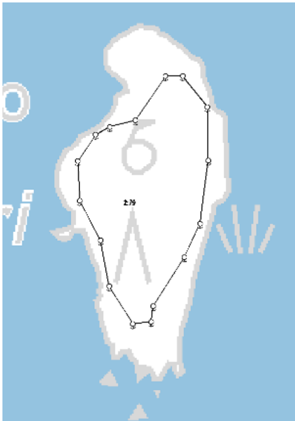
Kuva 14. Putkipyykkien rakentaminen murtoviivojen taitteisiin
