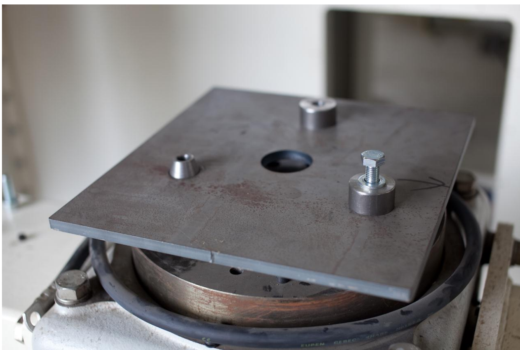
Kuva 15. Kiinnittimen pohjaan hitsattava vastinlevy.
