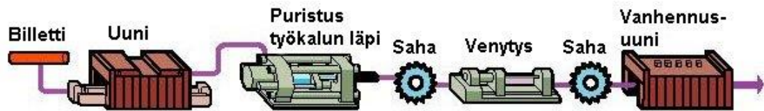
Kuvio 7. Alumiinin pursotusprosessi (Lähde: AEC)
