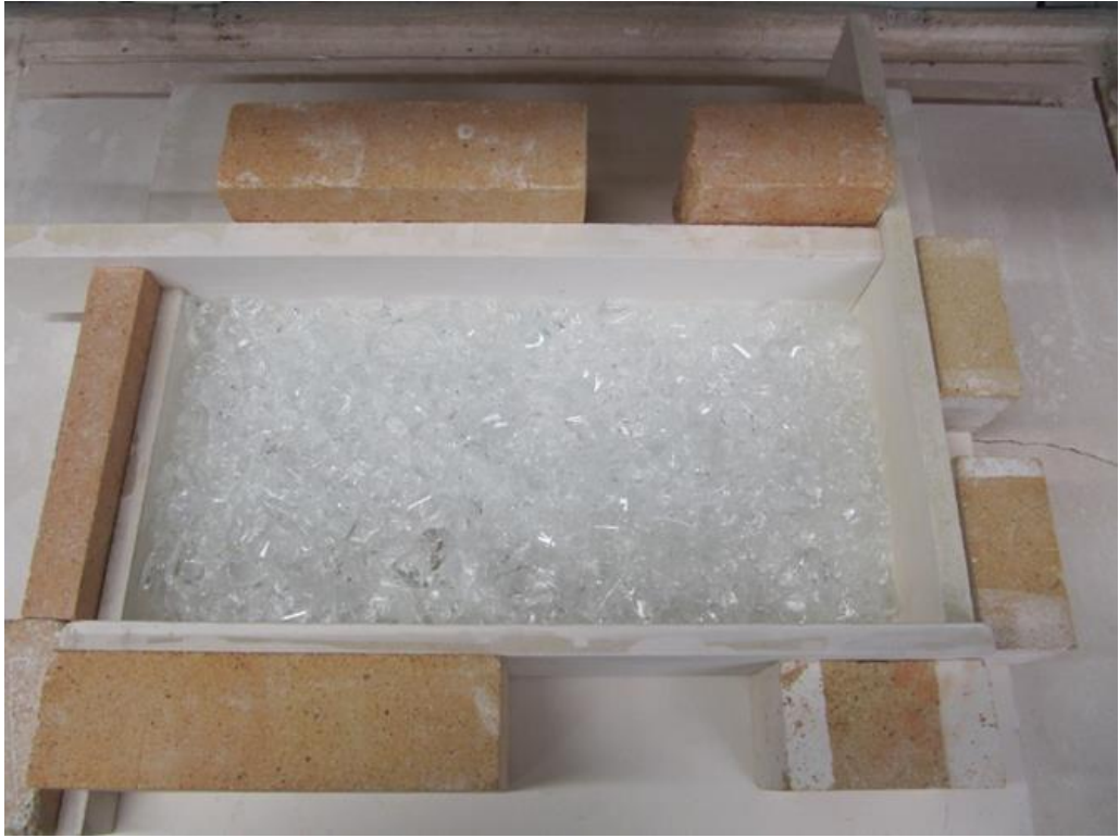
Kuva 19. Lasimurska rajoittimien sisällä uunissa ennen sulatusta
