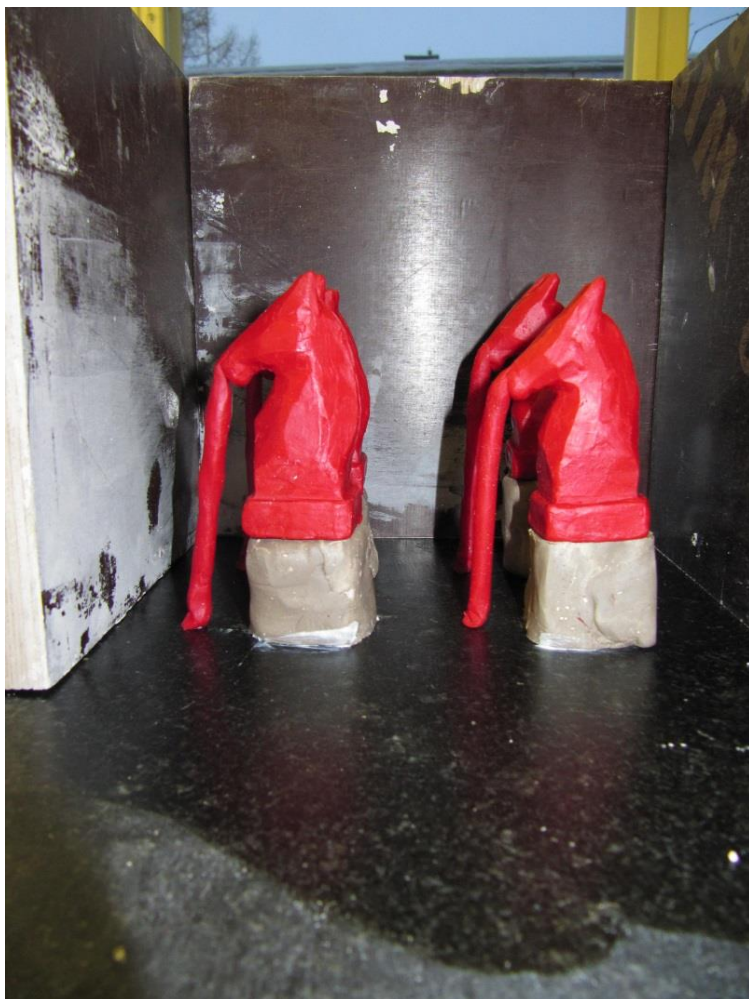
Kuva 18. Ratsujen ilmaukot punavahasta tehtynä
