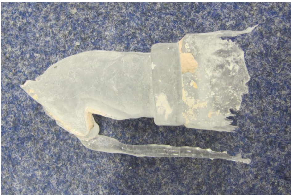
Kuva 22. Ylimääräinen lasi nappuloissa
