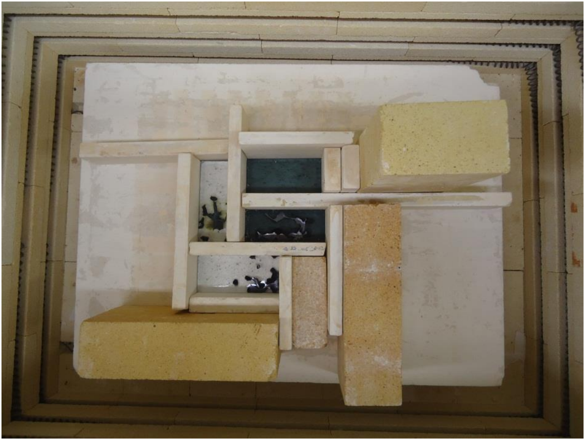
Kuva 7 Koepalat uunissa rajoittimien sisällä
