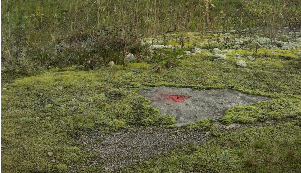
Kuva 18. Esimerkki luotettavasta pisteen perustamistavasta suuressa liikkumattomassa kalliossa. Pisteellä lisäksi selkeä keskusmerkki. (Kuva Tuomas Toivonen.)
