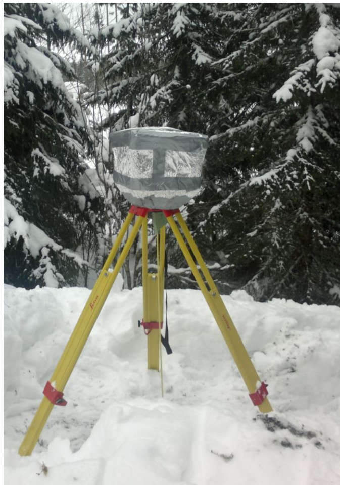
Kuva 27. Käytettävä vastaanotin peitettiin foliosta tehdyllä laatikolla, joka esti satelliittisignaalin vastaanottamisen. (Kuva Tuomas Toivonen.)
