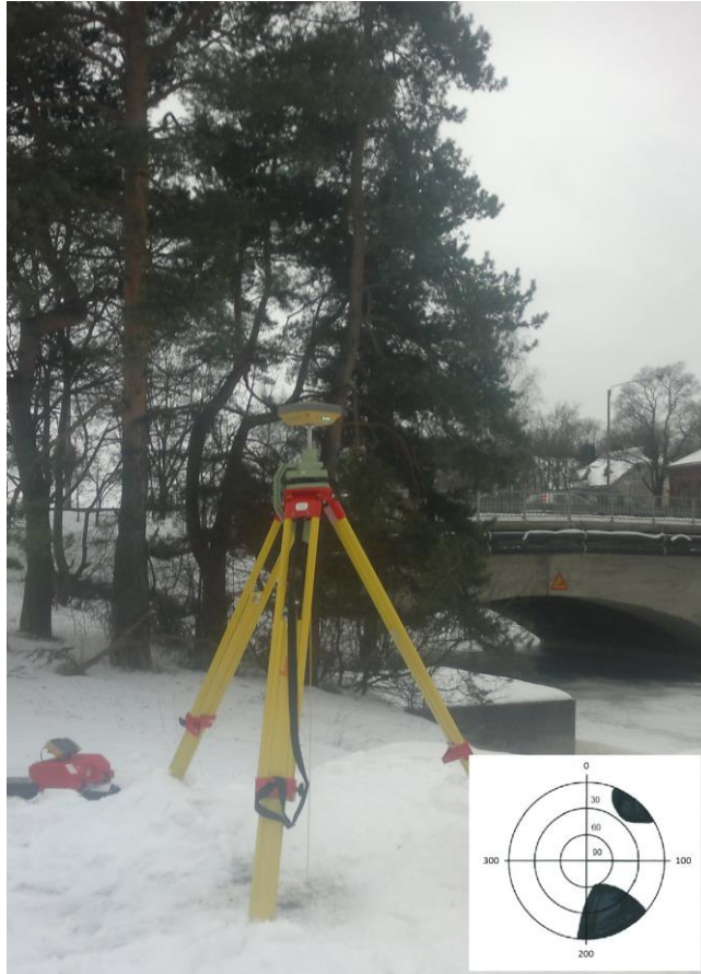
Kuva 13. Kuva pisteeltä 0102. Jopa yksittäiset puut voivat haitata mittauksia. Oikeassa alakulmassa myös pisteestä piirretty estepiirros, joka osoittaa esteiden suunnan (piirroksessa pohjoinen ylhäällä). (Kuva Tuomas Toivonen.)
