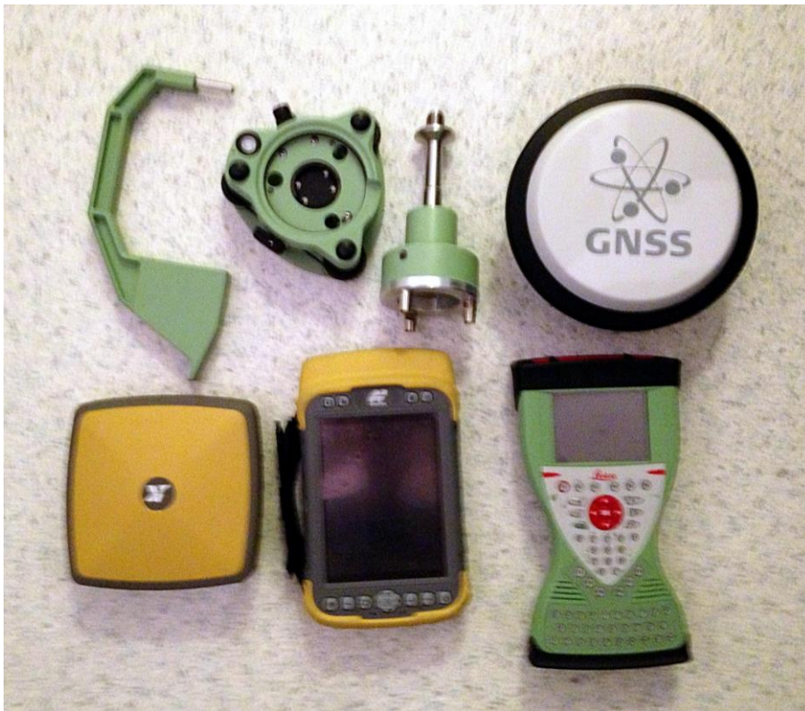
Kuva 23. Insinööriyön mittauksissa käytetyt RTK-kalustot. Ylärivissä korkeusmittari, pakkokeskistysalusta optisella luodilla, kannatin kierteellä sekä Leican GNSS-antenni. Alhaalla Topconin antenni ja maastotietokone sekä Leican maastotietokone. (Kuva Juho Ylikoski.)
