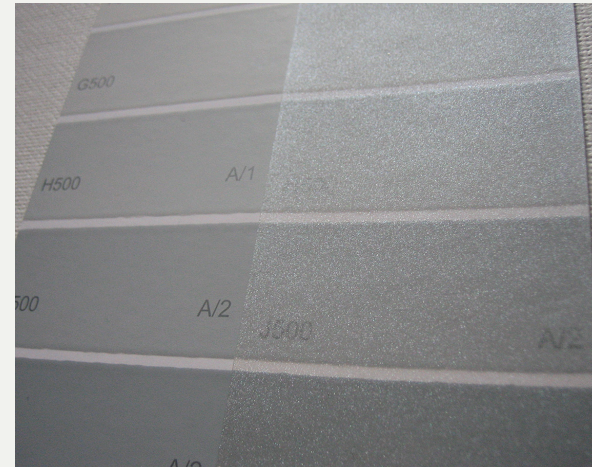
Kuva 141. Helmiäien vaikutus maalin sävyyn on voimakas. Kuvan näytessä maaliin lisätty hopean väristä helmiäistä
