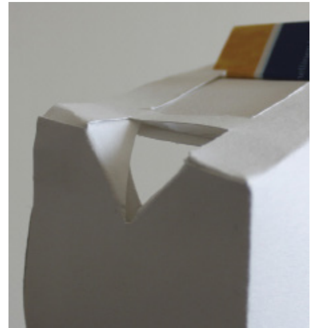
Kuva 22. Epäonnistunut prototyyppi kaatoaukosta, jossa oli siivekkeet. Valokuva Lievonen, B. 2013
