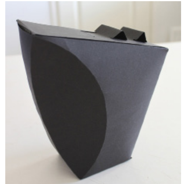
KUVA 21. Prototyyppi malli numero 2:sta. Vetokoukun korvasi kaksi uloketta, jotka estivät avausmekanismin läppää liikkumasta sivuttaissuunnassa. Valokuva Lievonen, B. 2013.
