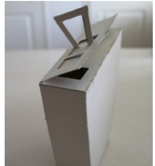
Kuva 18. Ensimmäinen prototyyppi. Kartongista valmistettu prototyyppi malli nro 2:sta. Valokuva Lievonen, B. 2013
