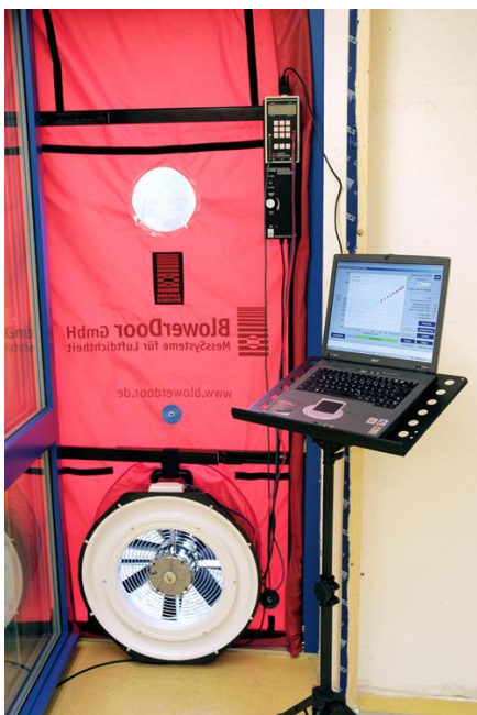
KUVA 3. Blowerdoor Basics -tiiveysmittauslaitteisto (Oy Teknocalor Ab 2012)
