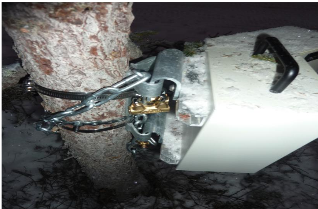
Kuvio 16. Liikennelaskurin kiinnitysosat
