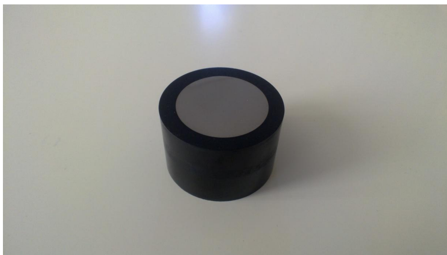
KUVA 8. Pinnoitetusta kappaleesta valmistettu poikkileike.
