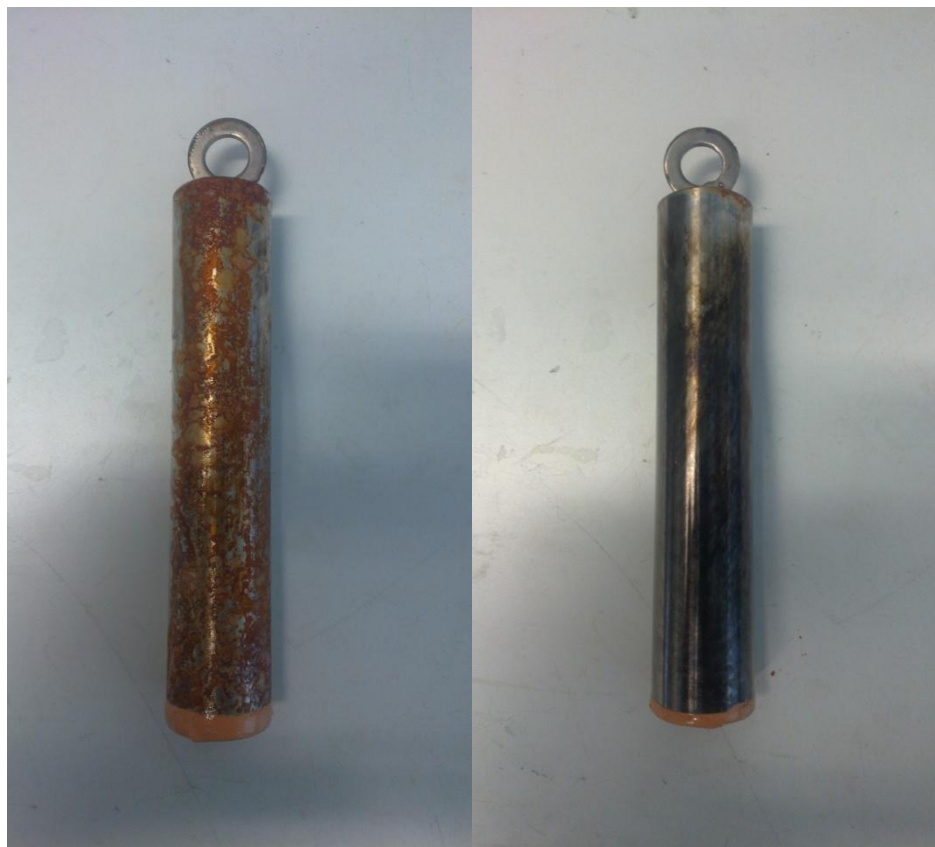
KUVA 12. Kuvassa vasemmalla on kappale, joka on pinnoitettu virrantiheydellä 10 \text{ A/dm}^2 ja oikealla kappale, joka on pinnoitettu virrantiheydellä 12 \text{ A/dm}^2 .
