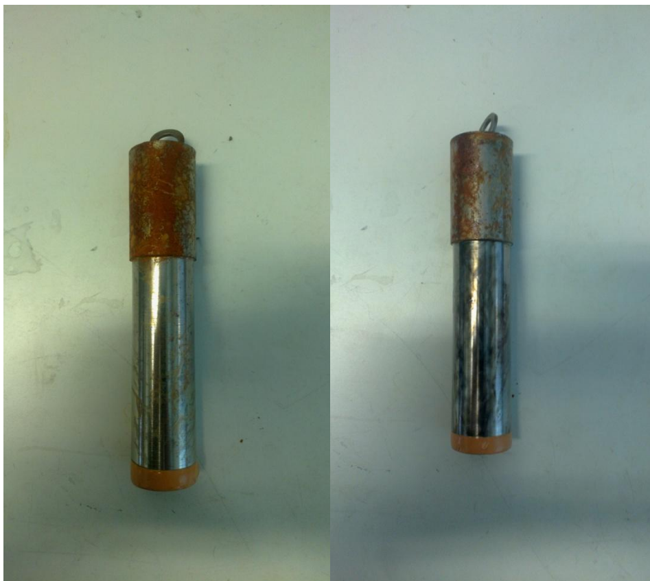
KUVA 10. Kuvassa vasemmalla on kappale, joka on pinnoitettu virrantiheydellä 2 \text{ A/dm}^2 ja oikealla kappale, joka on pinnoitettu virrantiheydellä 4 \text{ A/dm}^2 .
