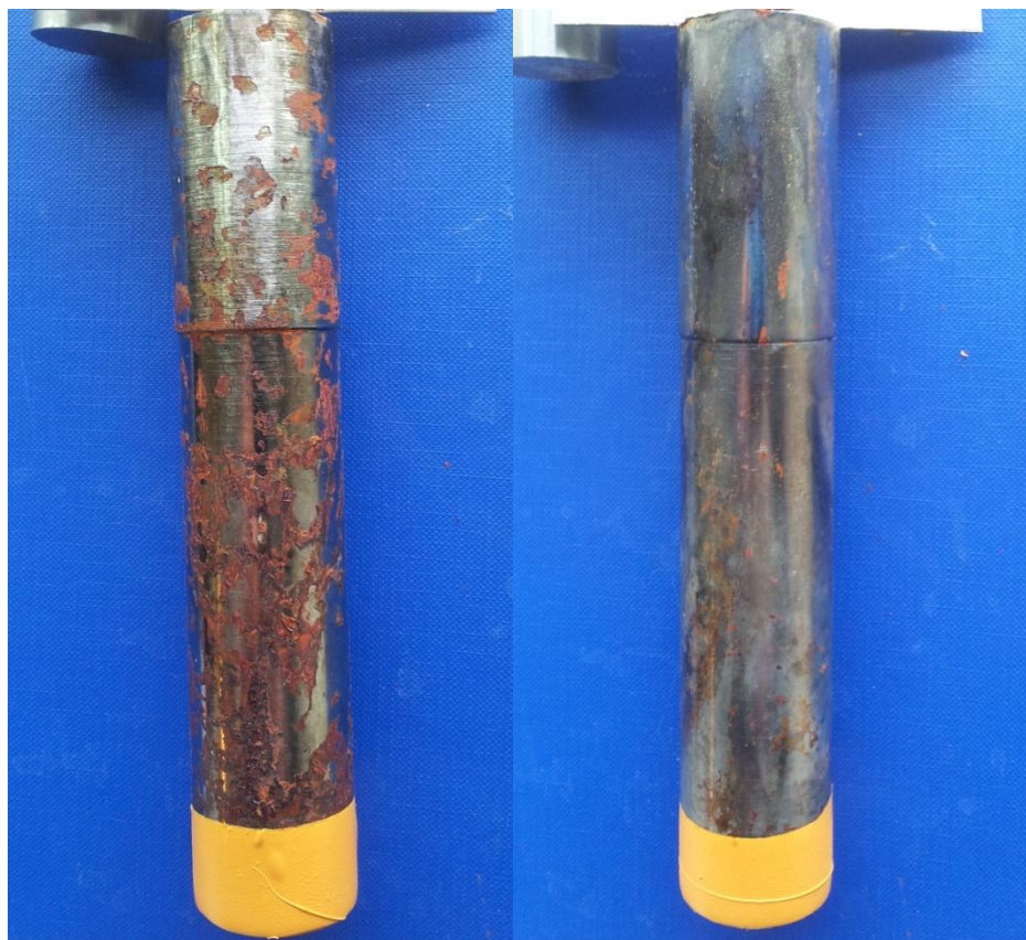
KUVA 13. Kuvassa vasemmalla on kappale, joka on pinnoitettu nichem 1122:lla ja oikealla kappale, joka on pinnoitettu nichem 1142:lla.
