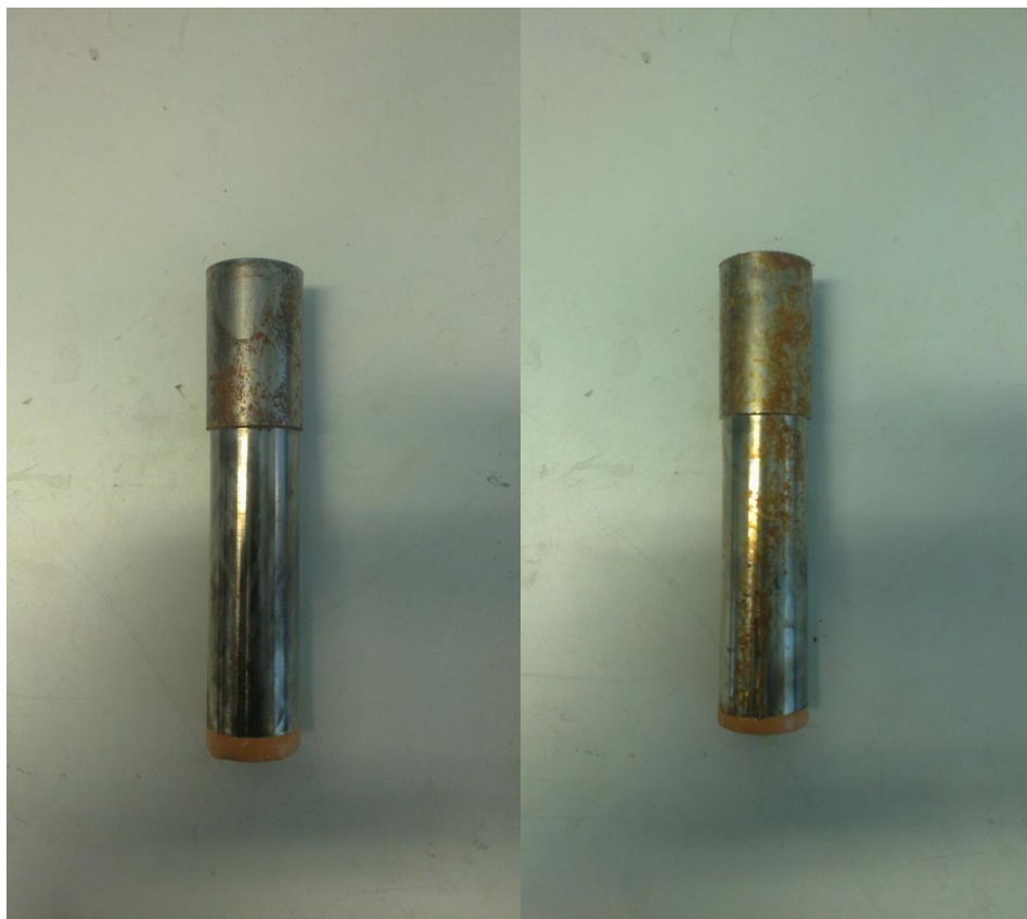
KUVA 11. Kuvassa vasemmalla on kappale, joka on pinnoitettu virrantiheydellä 6 \text{ A/dm}^2 ja oikealla kappale, joka on pinnoitettu virrantiheydellä 8 \text{ A/dm}^2 .
