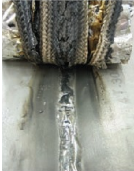
Kuva 4 Lasikuitualumiinifolionauha ruutumattoman teräksen takapinnalla (Aquasol Corporation. [viitattu 12.3.2013]).
