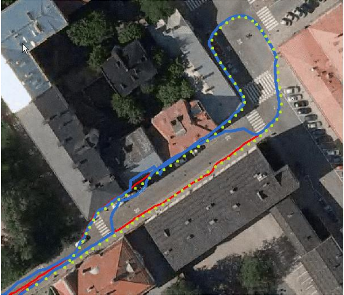
Kuva 13. Jälkilaskennan vaikutus mittauksiin. Punaisella viivalla nähdään jälkilaskettu tiedosto ja sinisellä viivalla korjaamaton tiedosto. Vihrein palloin merkitty viiva kuvastaa kuljettua reittiä.
