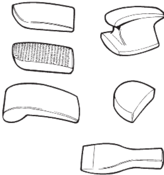
KUVA 34. Vastinrautoja (Petriläinen, Y. 1998. Auton korikorjaus, 34)
