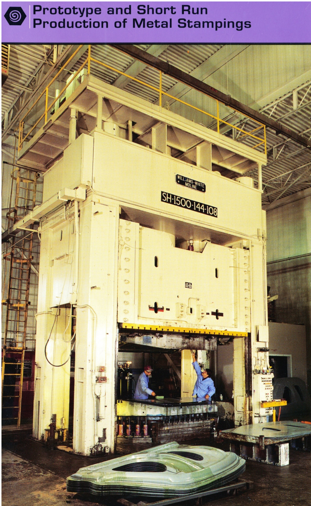
KUVA 12. Syvävetotyökalu ja korin kylkipaloja (Opetusmateriaali, Tauno Kulojärvi, Henkilöautojen korit, 5)
