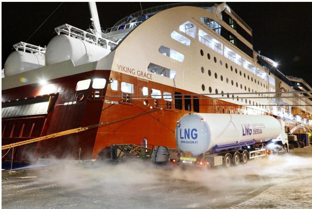
Kuva 18. Voimakasta höyryn muodostumista tankkauksen yhteydessä (Gasum)
