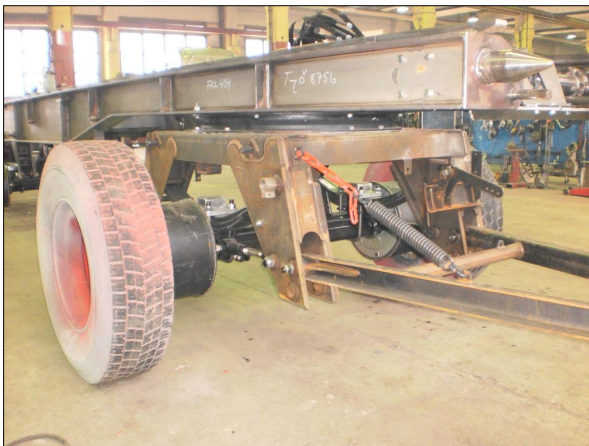
KUVA 2. Etuvaunu kiinnitettyä perävaunuun. (Valokuva Pekka Parviainen 2013)
