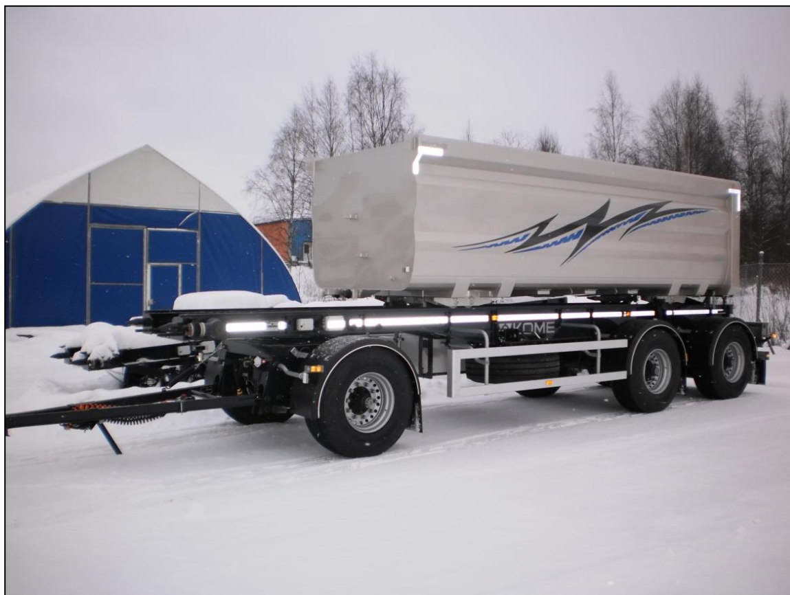
KUVA 1. Soralavalla varustettu automaattikasettiperävaunu. (Valokuva Pekka Parviainen 2013)
