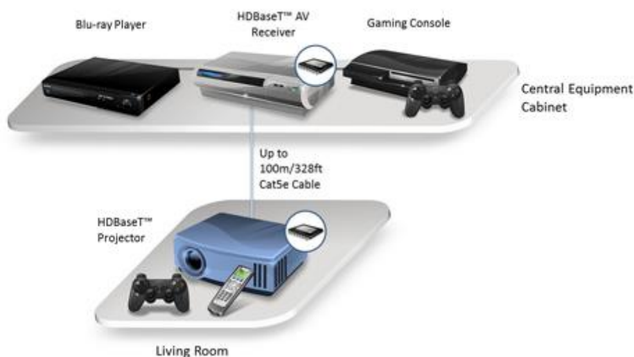
KUVA 11. Kotiteatteriympäristö (Valens. Solutions. HDBaseT in Action)
