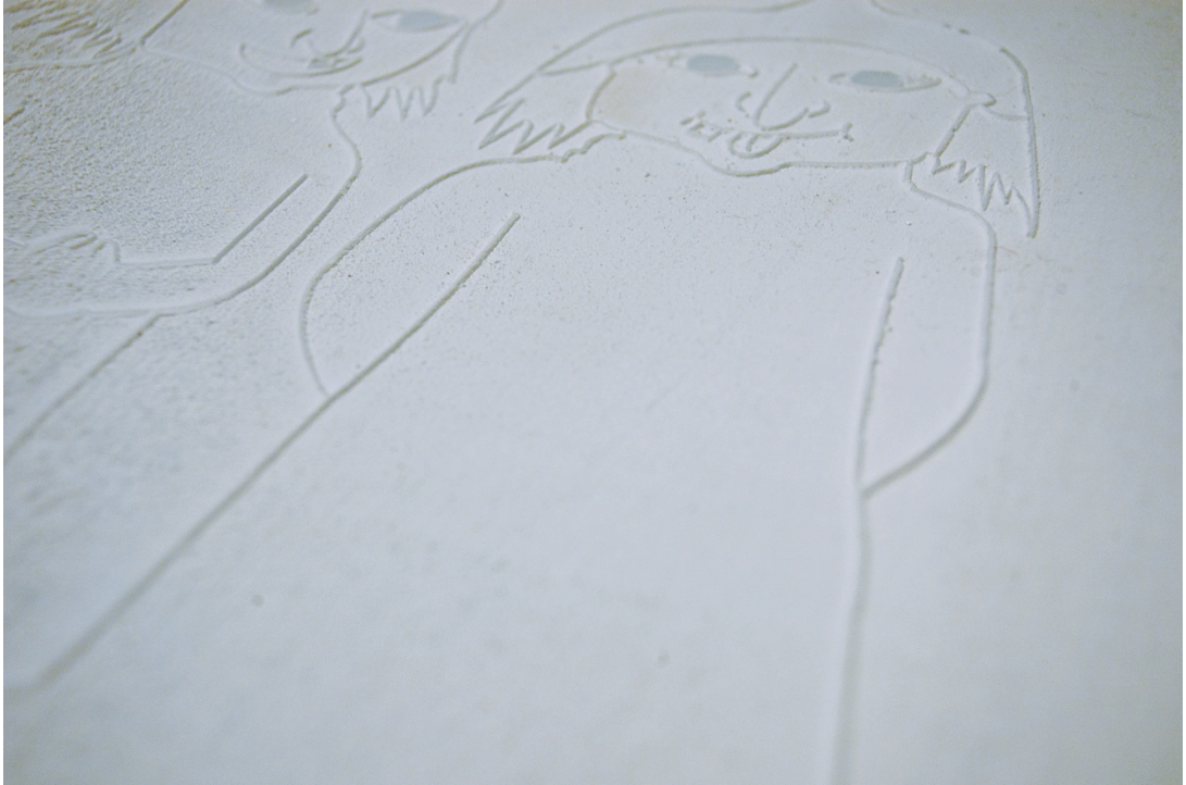
Kuvio 11. Muovista laserleikattu muotti preeglaukseen.
