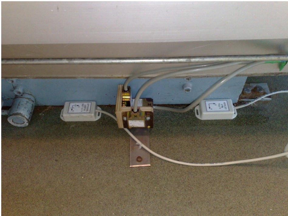
Kuva 8. Kiihtyvyyssanturit kiinnitettynä paikoilleen paarien viereen.
