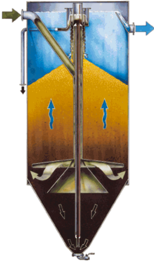
Kuva 3. Jatkuvan suodatuksen periaatekuva. /13/
