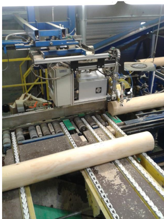
Kuva 6. Höylättyjen liimahirsien katkonta määrämitta. Kuva Rauha Repo 2013
