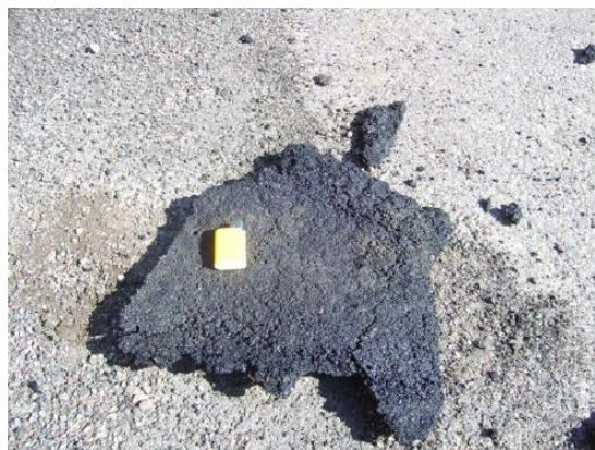
KUVA 29. Uudelleenlämmitystä varten kappaloitu valuasfalttipala (Huuskonen ym., 2009)
