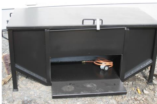
KUVA 32. PAB- paikkausmassan lämmitin (Kuva: Risto Rauva 2011).
