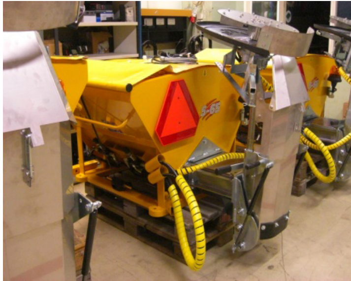
Kuva 34. Letkut ovat metalliputkissa.
