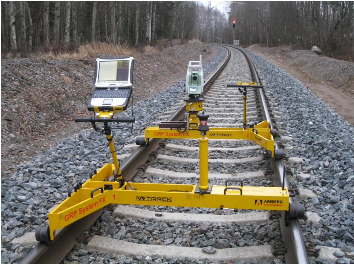
Kuva 4. Amberg GRP 1000 System FX -raiteenmittausjärjestelmä (kuva: Janne Rantala ©)
