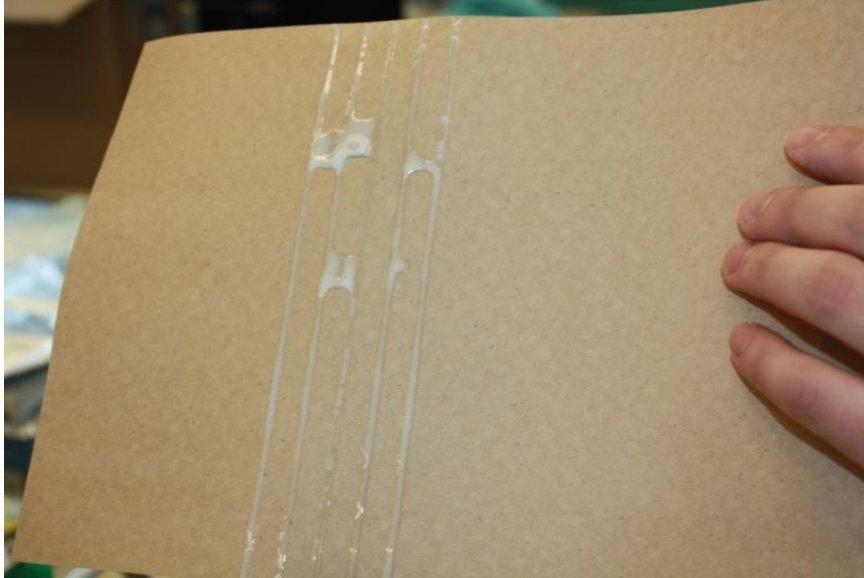
Kuva 15. Epäonnistunut liimavana, koska liimavanat eivät ole tasaisia.
