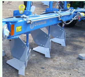
Kuvassa olevan auran kaasuhydraulisissa laukaisinlaitteissa paineensäätö on kaikille terille yhteinen.
