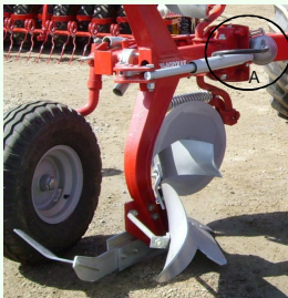
Kuvassa kaasuhydraulinen laukaisinlaitte, jossa paine säädetään teräkohtaisesti. Kunkin laukaisimen paineakkuun (A) voi asettaa oman paineensa, joka säätelee kyseisen laukaisimen toimintaa.
