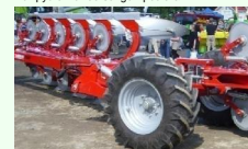
Hinattavassa väunaurassa tukipyörät ovat myös keskellä.
