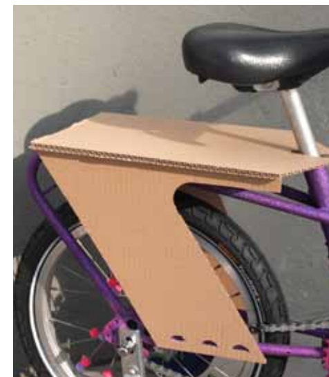
Toisessa protomallissa muotoilin tavaratelineen jalat kevyemmiksi ja hain niihin siipimäistä vaikutelmaa.
