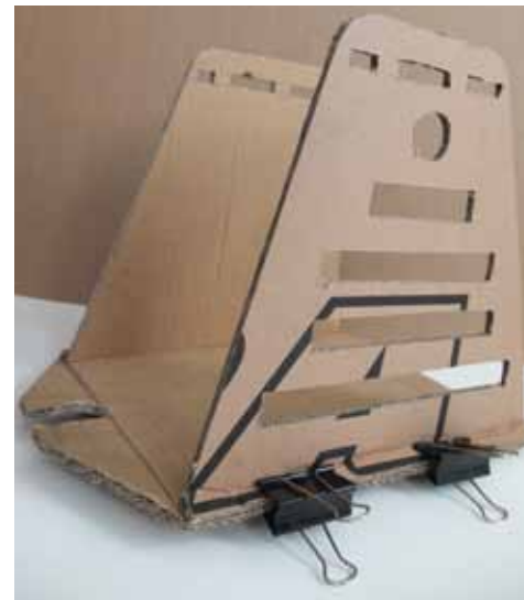
Ensimmäinen protomalli pahvisesta tavaratelineestä liimausvaiheessa. Raakaversiossa kokeilin leikattuja muotoja visuaalisina elementteinä.
