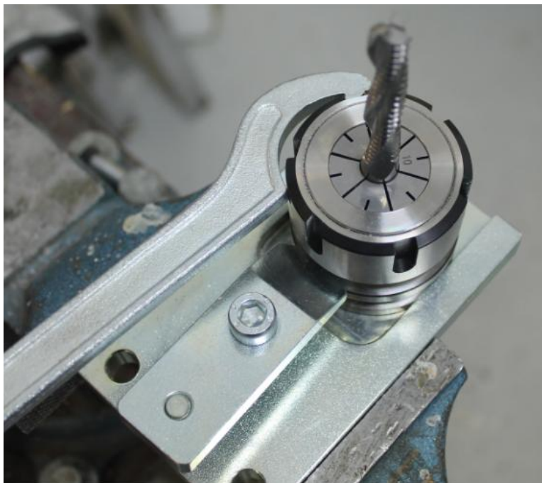
Kuva 13 terän 3. irrottaminen istukasta
