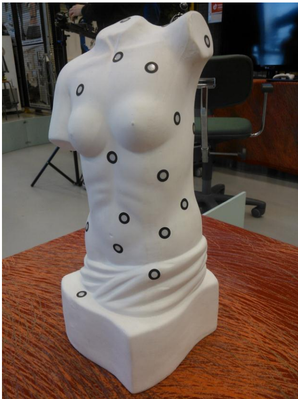
KUVIO 4. Esimerkki kohteen pinnalle kiinnitetyistä kohdemerkeistä
