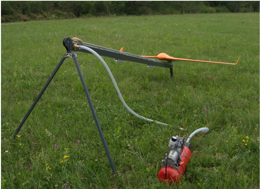
Kuvio 9. Kompressori lataa katapulttiin halutun ilmanpaineen. (C-ASTRAL 2013)
