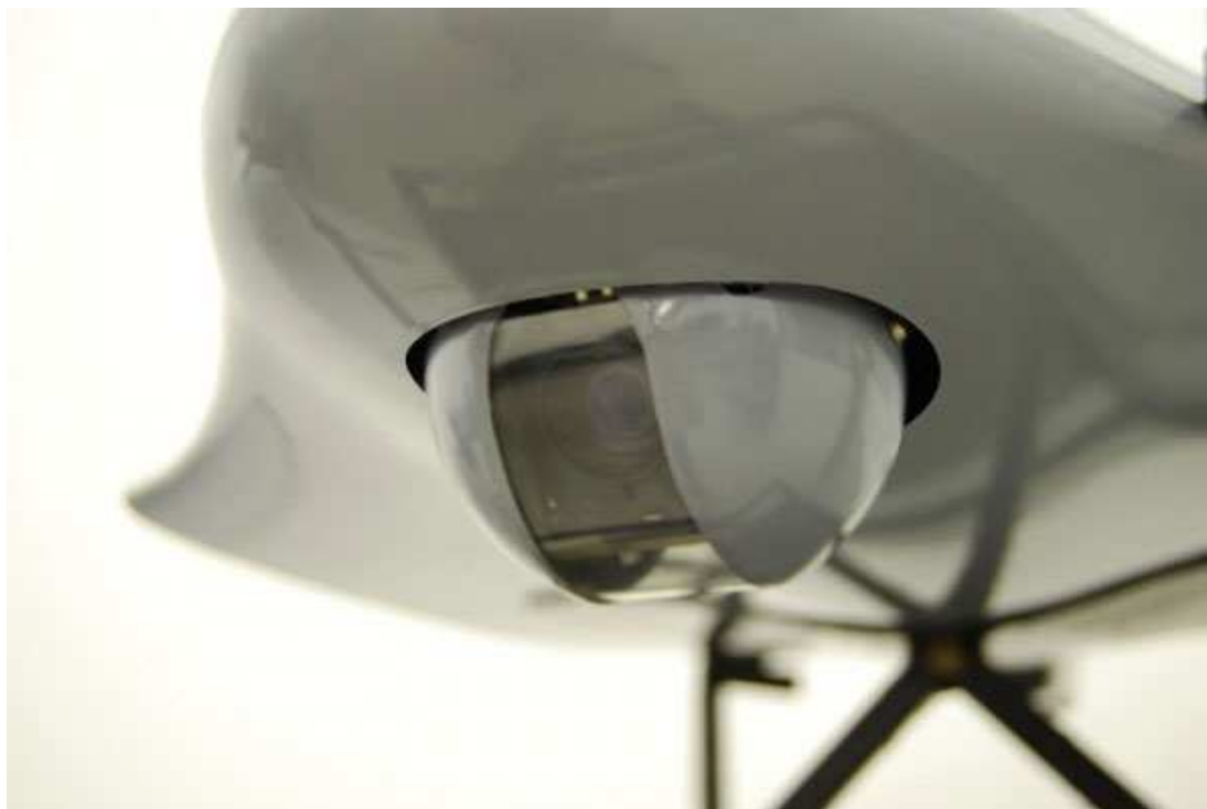
Kuvio 10. Lennokin kamera-aukkoon asennettu pyörivä Gimbal-videokamera. (C-ASTRAL 2013)
