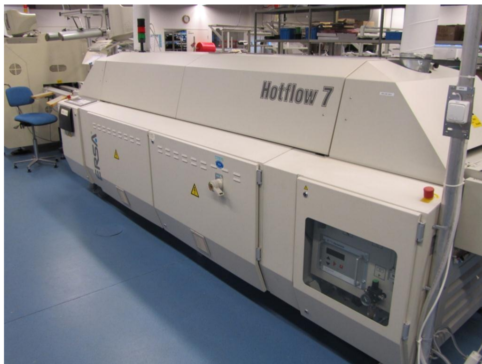
KUVA 2. Reflow-uuni: ERSA Hotflow 7 (valokuva Jani Ollikainen.)
