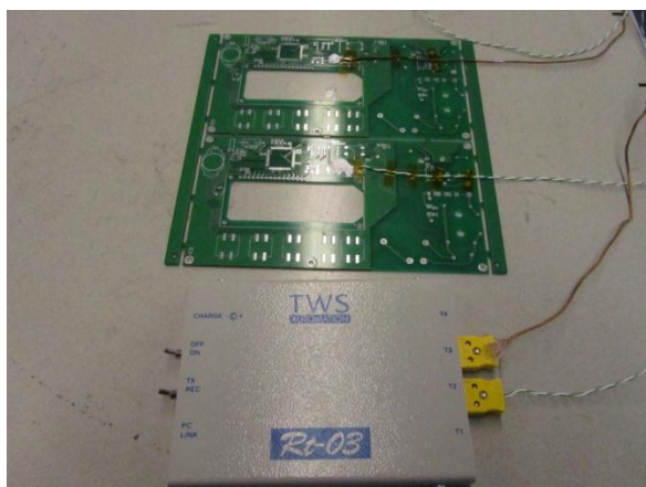
KUVA 4. Profilointilaitte ja siihen liitetyt termoparit ovat kiinni testikortissa (valokuva Jani Ollikainen.)
