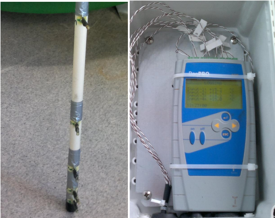
KUVA 5 Lannan lämpötilaa seurattiin termoelementtilangoilla, joista tieto tallentui loggerille (oikealla) (Kuva: Teija Rantala)
